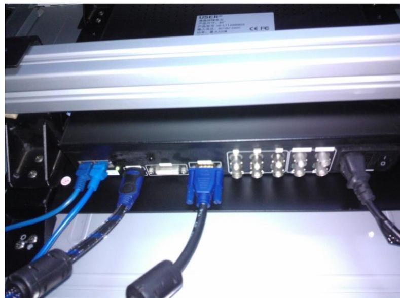
可以为一个拼接单元提供多个信号输入，包括 HDMI/VGA/AV/DVI等，调节信源显示不同画面
