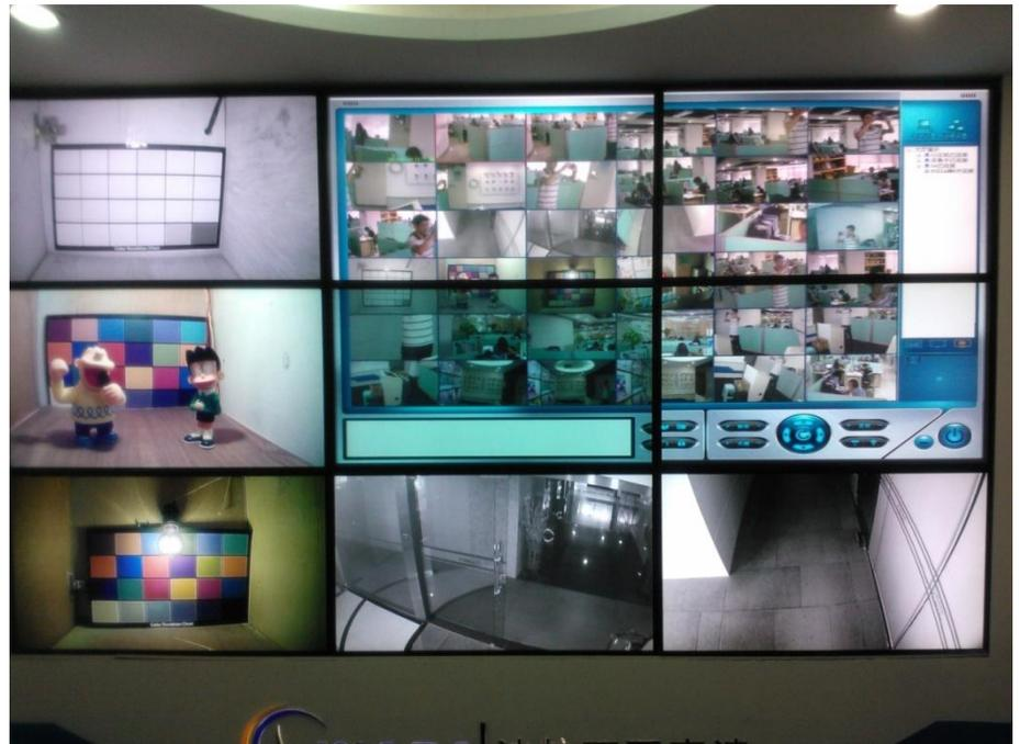
公司展厅实例：四屏合并-中控，五块单屏各自连接五个HDMI解码盒
